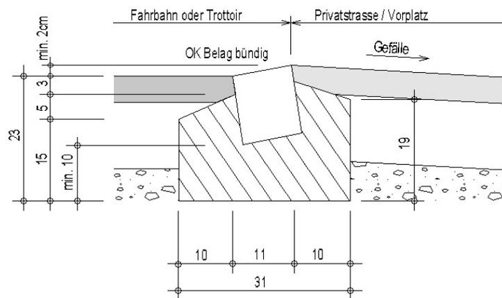
Pflastersteine 11/13cm, Granit einreihig, Beton C 20/25 XC1 0.058/m<sup>3</sup>
