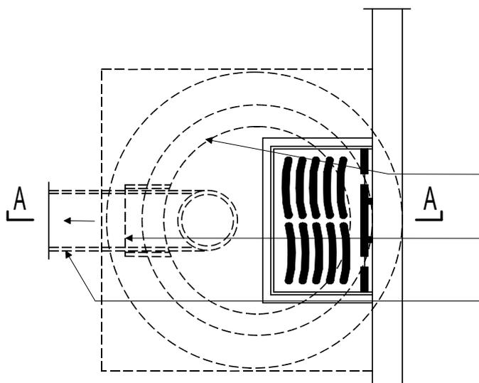
Einlaufschächte dürfen nur über einen Schlamm-sammler an den Sickerschacht oder das Trennsystem angeschlossen werden (Regelung über Mineralölabscheideanlage beachten)
