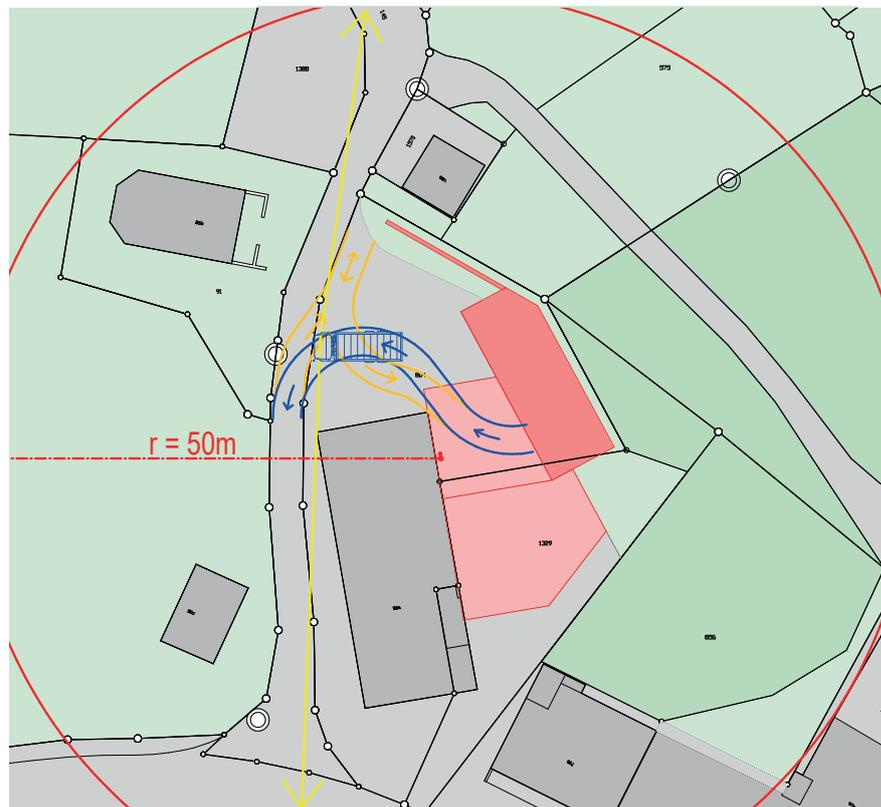
Abb. 12 Planausschnitt mit geplanter Zu- und Wegfahrt (orange bzw. blau) sowie Sichtweite (gelb); Quelle: Allotherm AG
