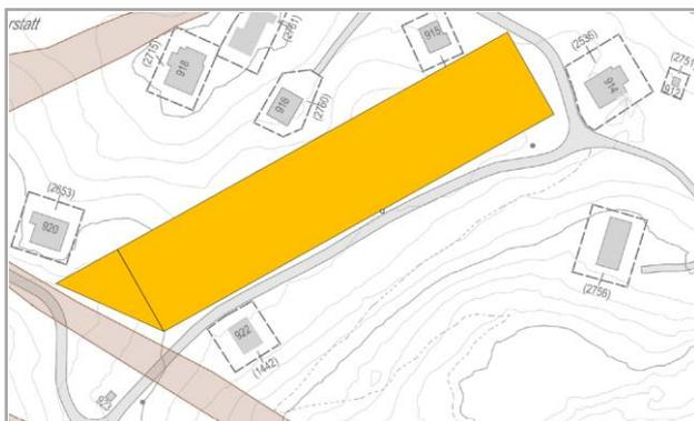
Zur Schonung des Bodens ist eine Bauplattform geplant. Allenfalls tangiert sie eine Piste. Daher wird noch geprüft, welcher Teil eventuell jeweils entfernt werden muss, um den Skibetrieb nicht zu beeinträchtigen. Ausserhalb der Bauzeiten ist die Plattform weitgehend ohne Material (verschneite Fläche im Winter). Nach der Bauphase wird sie entfernt.
