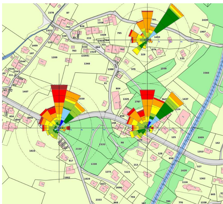
Abbildung 18: Windrosen auf drei benachbarten Rasterflächen von GRAMM um den Anlagestandort. Aufteilung nach Windgeschwindigkeit (blau niedrig, rot hoch). Quelle Hintergrund: Amtliche Vermessung des Kantons Bern, geodienste.ch.
